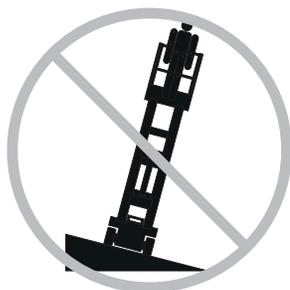
No confíe en la alarma de inclinación como indicador de nivelación. La alarma de inclinación instalada en el chasis sólo suena cuando la máquina se encuentra en una pendiente.
