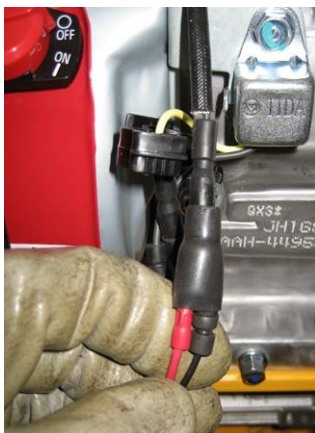
2 CONNECTER LE CABLE ROUGE AUX CABLES
