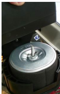
1 REMOVA A TAMPA DO FILTRO DE AR
