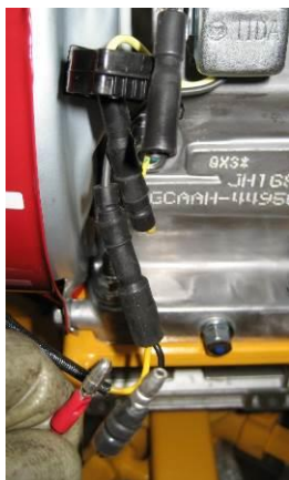
1 DESCONECTAR EL CABLE NEGRO DE LA BUJÍA
