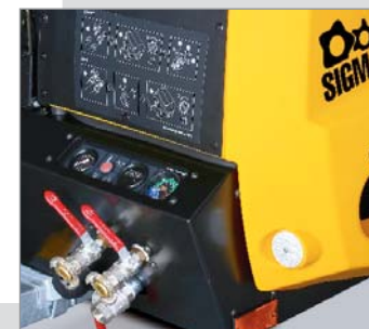
La fotografía muestra un M 43 con llave de bola G1 opcional
